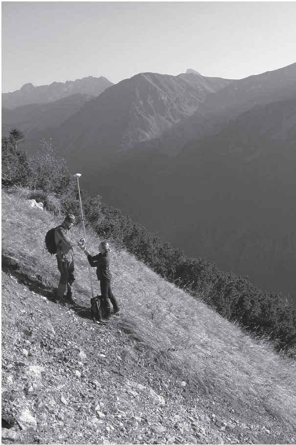
Obr. 3. Zameranie pôdnej deštrukcie prístrojom GPS v záujmovom území Liptovské Kopy (2010). Foto: Helena Sedláková
