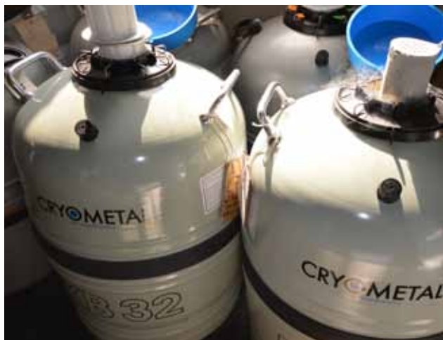
Obr. 2. Úschova kvasiniek v tekutom dusíku pri -196\text{ }^{\circ}\text{C} . Foto: Hana Dudášová
